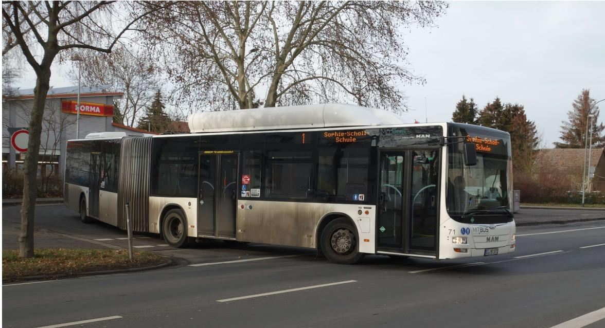
Abbildung 7: Gießener Stadtbus der Linie 1 verlässt die Wendeschleife Waldweide; das Fahrzeug gehört der MIT.BUS GmbH und zeigt den typischen, hohen Dachaufbau mit Erdgastank (Foto B. Sanner).
