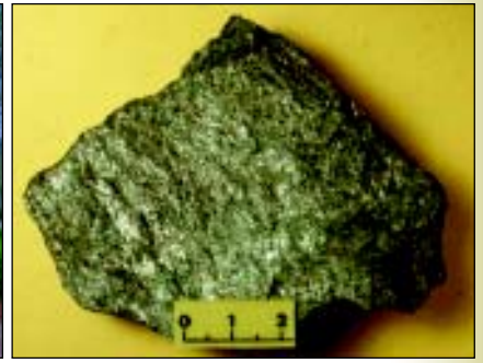
Abb. 2: Der Untergrund am Standort der Versuchsanlage besteht aus Glimmerschiefer (links ein Aufschluß ca. 200 m entfernt)
