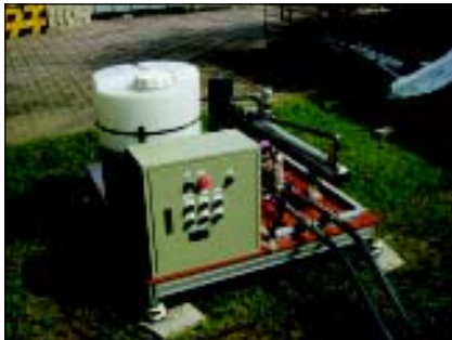
Abb. 3: Gerät zum Thermal Response Test, in Korea nach deutschem Vorbild gebaut (Sommer 2003)
