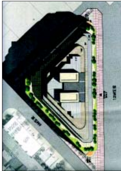
Abb. 11: Aufsicht des geplanten Gebäudes (links) sowie Vorschlag zur Anordnung der Erdwärmesondenbohrungen in der Baugrube (rechts, mit eingezeichneten Stützen des Gebäudetragerwerks); der Blick in Abb. 10 geht von unten rechts auf das Grundstück
