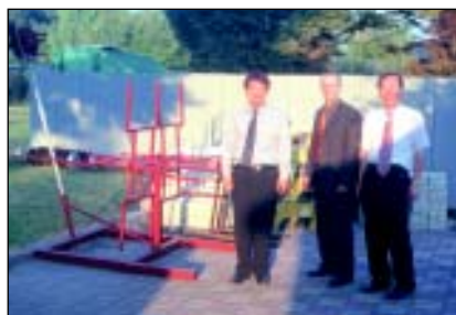
Abb. 9: Haspel zum Einbau von Erdwärmesonden; daneben Dr. Byoung-Youn Choi, HP System Tech, Dr. Erich Mands, UbeG GbR, und Y. Chul Park, Todah Corporation (Oktober 2003)
